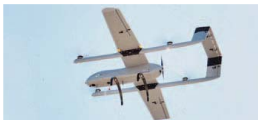
Dron tipo VTOL. El desarrollo del VTOL (de ala fija con capacidad de despegue y aterrizaje vertical), corrió a cargo de Aeromedia: «Puede escanear muchas hectáreas en poco tiempo». X.F.R.
